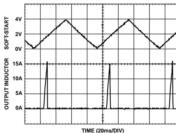
FIGURE 4. OVER-CURRENT OPERATION
