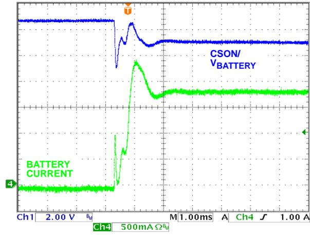
FIGURE 12. BATTERY INSERTION
